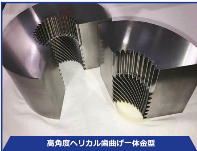
セグメント方式によりクラウニング成形が可能に！
