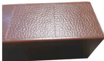
革のスキャンデータをCraft MILLでプログラム作成して、モデリングマシンで削ったサンプル。全てタイ国内で対応可能
